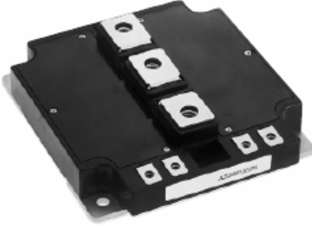
Fig.1 CM600DU-24NF Dual IGBTMOD™ NF- Série Rating : 600 Ampères/1200 Volts [2]
